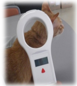
皮下に埋め込み リーダーで読み取る
